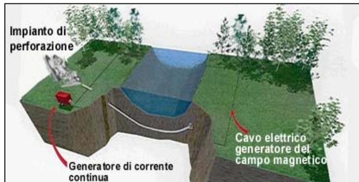
Il foro, che avrà un diametro di poco superiore alla testa di perforazione, permetterà il deflusso del fango in eccesso che verrà raccolto nella buca iniziale consentendo anche una costante circolazione dello stesso durante la perforazione.
