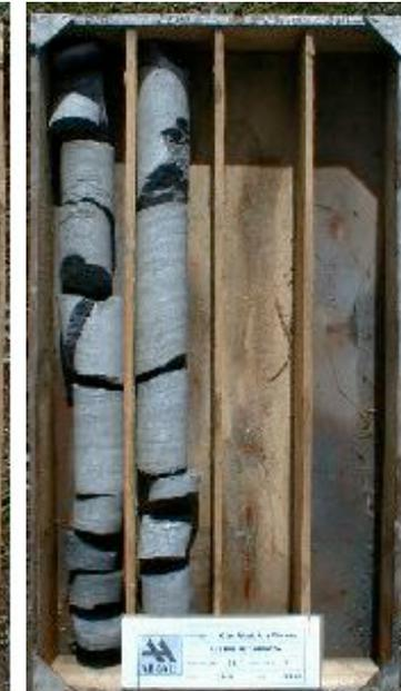
**Depositi di copertura di natura prevalentemente sabbiosa-limosa costituiti da elementi da centimetrici a decimetrici (fino a metrici) di calcescisti immersi in matrice limoso-sabbiosa a tratti prevalente; permeabilità media**
